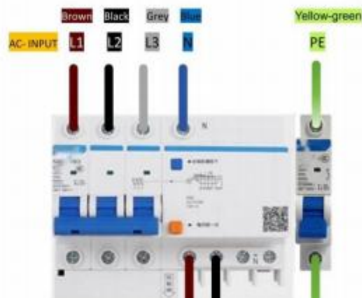
Schematic diagram of L1, L2, PE input wiring
